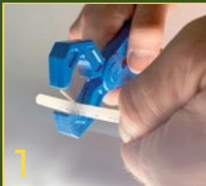
Mediante la pinza taglia tubi in dotazione, tagliare a 90° la parte del tubo assicurandosi che il taglio sia pulito, senza sbavature o schiacciamenti. Rimuovere eventuali ostruzioni prima di inserire completamente il tubo nel raccordo. L'inserimento del tubo richiede una forza moderata, non graffiare o danneggiare il tubo nell'operazione.
